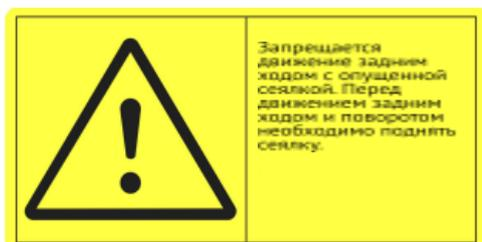
Запрещается движение задним ходом с опущенной сеялкой. Перед движением задним ходом и поворотом необходимо поднять сеялку.
