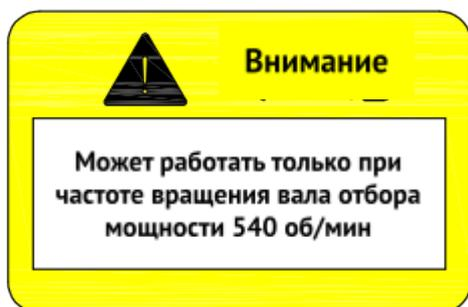
Этот знак означает, что сеялка может работать только в том случае, если отбор мощности достигает 540 оборотов в минуту.
